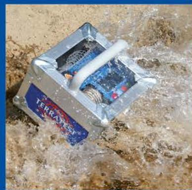
Der TERRATEST® Messcomputer besitzt einen geprüften Schutzfaktor von IP53 gegen Staub und gegen eindringendes Wasser.
